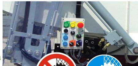
**Ripari fissi a chiusura delle zone che possono costituire rischio di cesoiamento**
